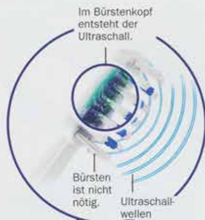
Die Zahnbürste von emmi-dent arbeitet mit Ultraschallwellen
